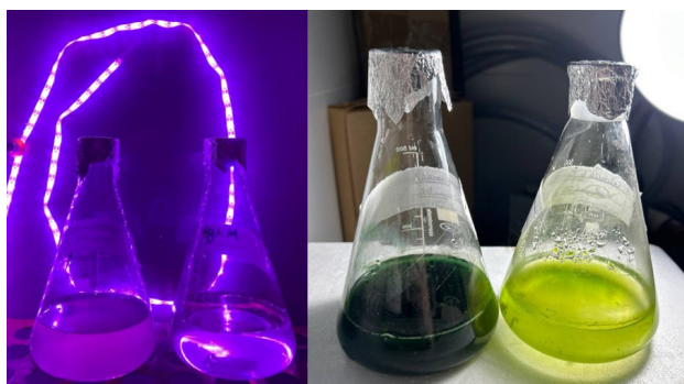
Рис. 2. Культивирование Cyanobacterium sp. B-1200 при: А – T=28^{\circ}\text{C} , E=220 лк, \lambda=380-780 нм; Б – T=23^{\circ}\text{C} , E=1440 лк
