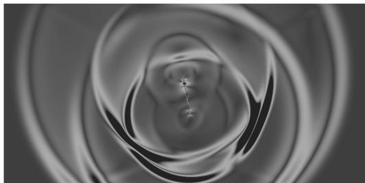
Рис. 2. Отклик от флюидонасыщенного разлома
