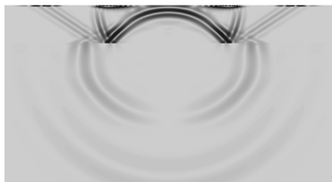
Рис. 5. Отклик включения в системе «лед — вода — грунт» от нефтесодержащего включения
