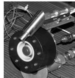
Рис. 9. Внешний вид двигателя НТ-100 Alta S.p.A
