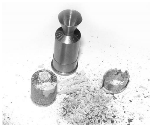
Рис. 1. Состояние тантал-вольфрамовой КС до и после отжига на воздухе
