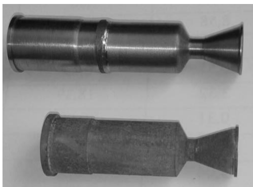
Рис. 2. Молибденовая КС в исходном состоянии и с защитным дисилицидным покрытием
