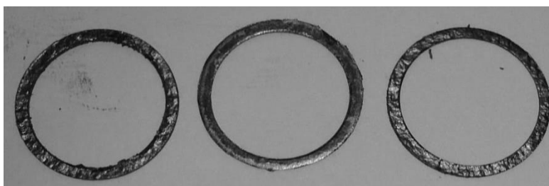
Рис. 3. Внешний вид прокладок «графлекс» для ТКД после испытаний на ЗТ
