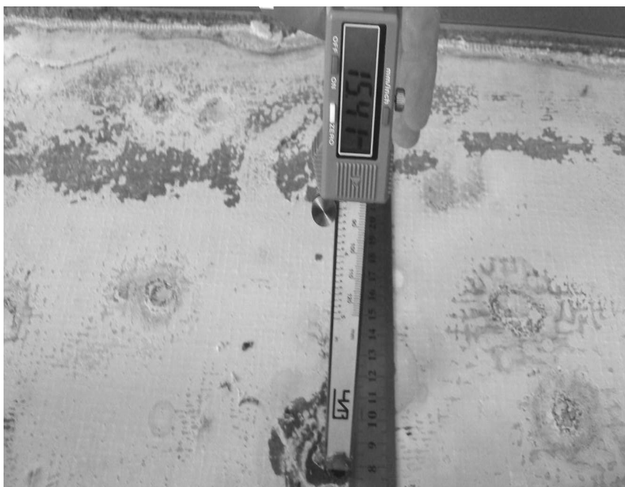
Рис. 2. Глубина лунки, образовавшейся в результате химической коррозии бетона
