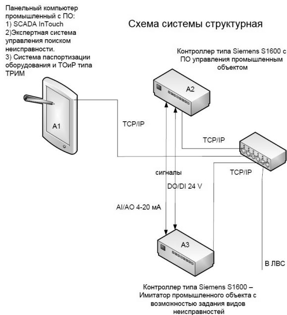
Рис. 2. Укрупненная схема создаваемого аппаратного комплекса обработки информационных технологий ранней диагностики
