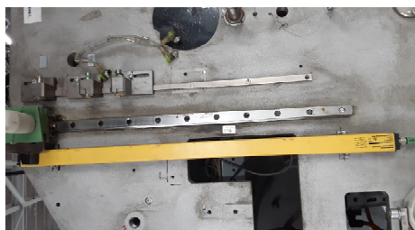
Рис. 3. Датчик линейного положения в установке на линии сборки KIA/Hyundai
