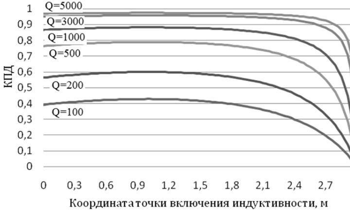
Рис. 8. Графики КПД антенны при различных значения добротности индуктивного элемента
