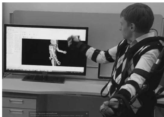
Рис. 6. Управление 3D-моделью робота с помощью костюма управления
