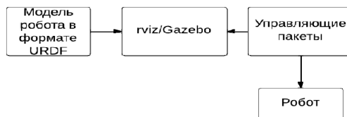
Рис. 3. Модель взаимодействия программных пакетов с инструментом rviz
