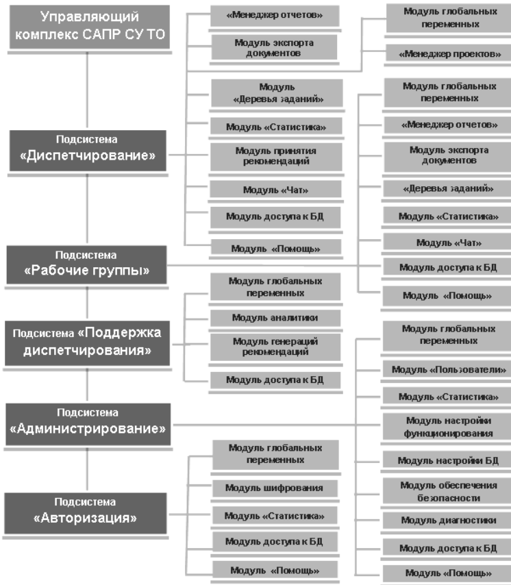
Рис. 1. Укрупненная структурная схема комплекса УК-01
